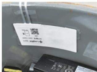
ドラム缶に装着したRFID温度ロガータグ
