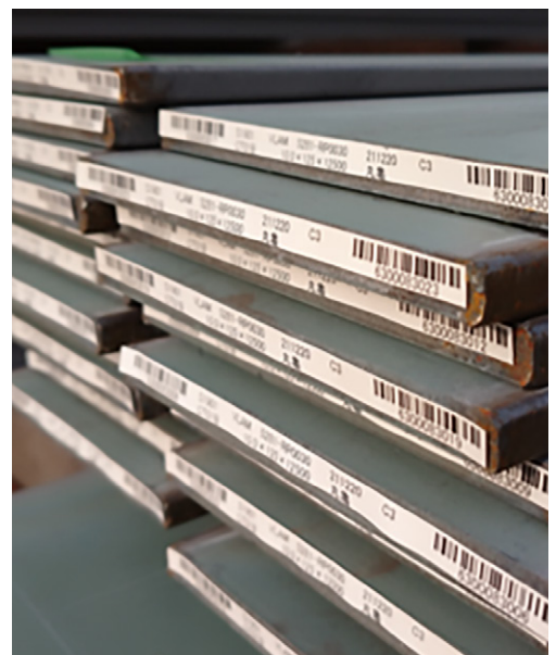
ラベルを貼った鋼材。保管・運搬期間にサビが発生してしまうことがあり、時にはサビの上に貼り付けしなければならないことも。それでも新しいラベルなら貼り付け可能で、剥脱が起きることもほぼない。
