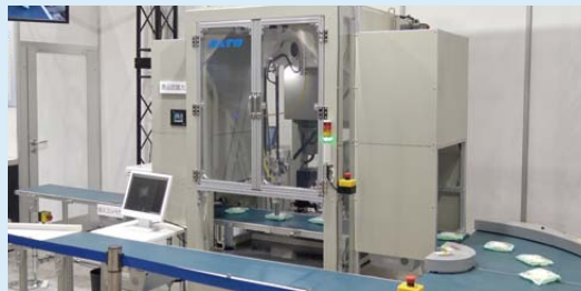
画像で認識し自動印字貼付けまで行う ロボットラベラー
