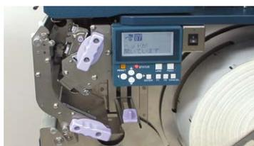
\*アシスト機能：ラベルのセットを容易にするため、通紙ルートの間隔を確保する機能です。
