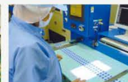
品質検査 高精度検査機と熟練のオペレーター による検査体制。印刷のわずかな ズレや文字欠けも見落としません
