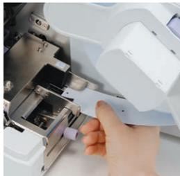
タグの先端を挿入するだけで自動で印字開始位置までセット。1枚目からムダなく印字可能。
