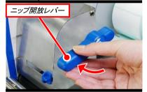
ニップ開放レバーを矢印の方向に移動さ せて、ニップローラをオープンします。 この時に、ラベルがセットされている場合
