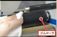
ウエスにプリンタ清掃液を染み込ませ、ゴ ムローラを手で回しながら清掃します。
