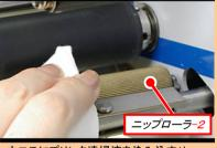
ウエスにプリンタ清掃液を染み込ませ、 ニップローラ-2を手で回しながら清掃しま
