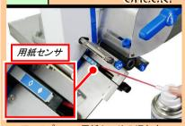
エアースプレーで用紙センサの汚れを 吹き飛ばします。
