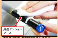
ウエスにプリンタ清掃液を染み込ませ、 供給テンションアームを手で回しながら 清掃します。
