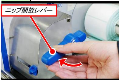
ニップ開放レバーを矢印の方向に移動させて、ニップローラをオープンします。
