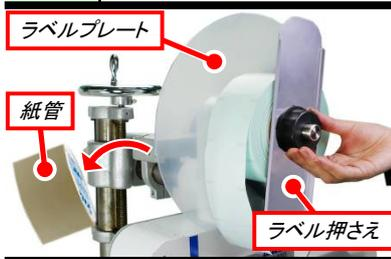
ラベル押えを手前に外した後、紙管を外します。次に、新しいラベルを奥側にセットし、ラベル押えをセットします。ラベル蛇行や貼付位置ずれの原因になるため、ラベルは、ラベルプレートとラベル押さえ間で、隙間、遊びがないようにセットしてください。
