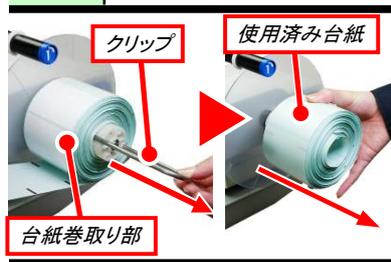
台紙巻取り部のクリップを手前に引き、使用済みの台紙を外します。
