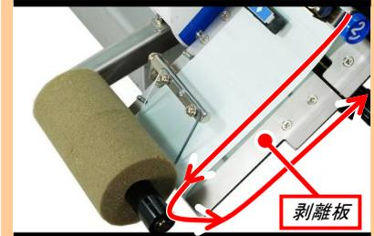
台紙を剥離板の先端で折り返します。
