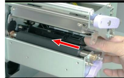
センサの溝に合わせ、センサカバーを奥まで差込みセットします。
