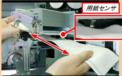
ウエスにプリンタ清掃液を染み込ませ、用紙センサの下に敷き、ウエスを左右に移動させて用紙センサの汚れを拭き取ります。
