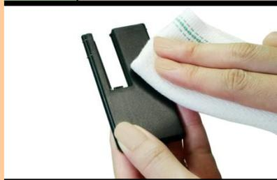
ウエスにプリンタ清掃液を染み込ませ、センサカバーを清掃します。**ラベルが貼り付いている場合は取り除いてください。**
