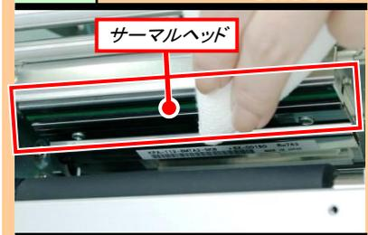
新しいウエスにプリンタ清掃液を染み込ませ、サーマルヘッドを清掃します。
