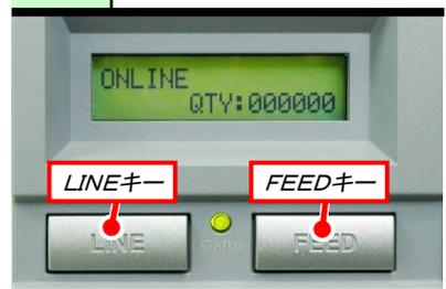
FEEDキーを押して、ラベルの頭出しを行なった後、LINEキーを押しON LINE状態にします。
