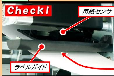
ラベルガイドと、用紙センサの下にラベルが通っている事を確認します。ラベルガイドと、用紙センサの上にラベルを通すと故障の原因になります。ラベルルート図参照
