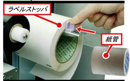
紙管を外し、新しいラベルをセットします。次にラベルストップをスライドしてラベルの幅に合わせます。ラベルストップの幅がきつ過ぎると紙送りに影響しますので注意してください。
