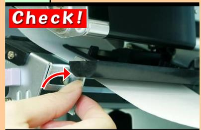
スライドガイドを起し、ラベルを奥側に合わせてセットした状態でラベルの手前の端が軽く触れるようにスライドガイドを合わせます。スライドガイドの幅がきつ過ぎると、紙送りに影響しますので注意してください。
