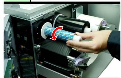
リボンリード紙テープの端を奥側に沿うように合わせてリボンコアに巻き付け、リボン面にしわがない状態で数回巻いてください。
