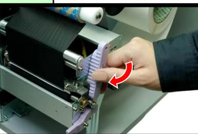
ヘッドロックレバーを矢印の方向に下げ、サーマルヘッドを閉めます。
