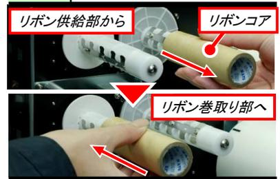
リボン供給部のリボンコアを手前の方向に引き抜き、リボン巻取り部の奥まで差し込みセットします。
