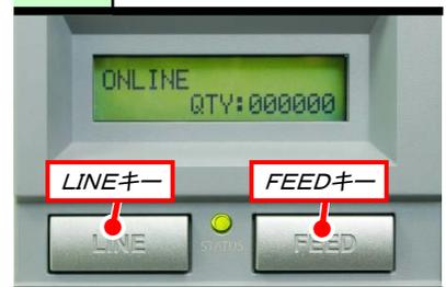
FEEDキーを押して、ラベルの頭出しを行なった後、LINEキーを押してON LINE状態にします。
