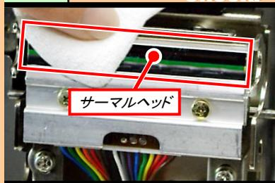
ウエスにプリンタ清掃液を染み込ませ、サーマルヘッドを清掃します。
