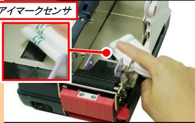
ウエスにプリンタ清掃液を染み込ませ、アイマークセンサを清掃します。
