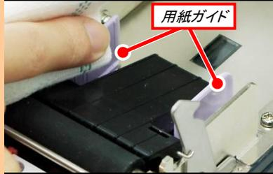
ウエスにプリンタ清掃液を染み込ませ、左右の用紙ガイドを清掃します。
