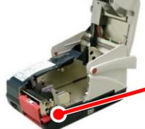
カバー開閉ボタンを押し下げて、カバートップを上を開きます。この時に、ラベルがセットされている場合は、外してください。
