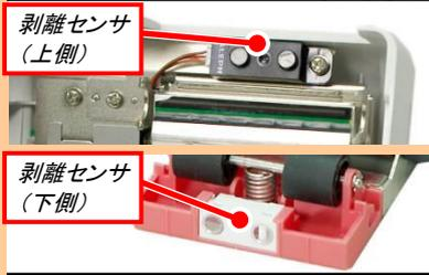
ウエスにプリンタ清掃液を染み込ませ、剥離センサ(上側)と剥離センサ(下側)を清掃します。
