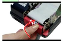
剥離フレームを持ち上げながら閉じ、押し 下げてピックしてください。
