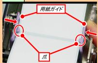
ラベルを出口まで引き出す際に、用紙ガイドをラベル幅に合わせ、尚且つ用紙ガイドの左右の爪の下にラベルを通します。 ラベルルート図参照
