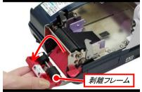
剥離フレームを押し上げたあと、軽く手前に倒し開けます。
