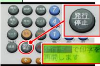
発行/停止キーを押すと自動的に頭出しを 行い、印字が再開されます。
