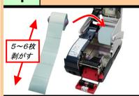
ラベルをセットし易くする為、台紙先頭から 5~6枚のラベルを剥がし、ラベルをガイド コアに入れてセットします。ラベルの向きを 間違えないようにしてください。 ラベルルート図参照
