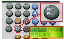
発行/停止キーを押すと自動的に頭出しを 行い、印字が再開されます。
