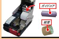
ガイドコアから紙管を取り除き、新しいラベ ルをガイドコアに入れてセットします。この 時にラベルが残っている場合は取り除いて ください。ラベルの向きを間違えな してください。**ラベルルート図参照**
