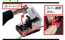
カバー開閉ボタンを下に押し、カバートップ を開けます。
