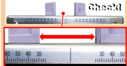
ガイドコアの幅がラベルの幅に合っているかを確認します。合っていない場合は、使用するラベルの幅(mm)に合わせて、ガイドコアを目盛の位置に調整してください。例:ラベル幅が30mmの場合はガイドコアを30に合わせます。ガイドの幅がきつ過ぎると、紙送りに影響しますので注意してください。
