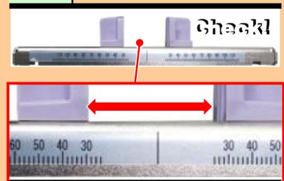
ガイドコアの幅がラベルの幅に合っているかを確認します。合っていない場合は、使用するラベルの幅(mm)に合わせて、ガイドコアを目盛の位置に調整してください。例:ラベル幅が30mmの場合はガイドコアを30に合わせてください。ガイドの幅がきつ過ぎると、紙送りに影響しますので注意してください。
