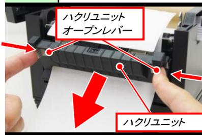
左右のハクリユニットオープンレバーを内側に押して、ハクリユニットを開けます。用紙と台紙は外してください。
