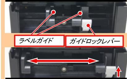
ラベルガイドの幅がラベルの幅に合っているかを確認します。合っていない場合は、ラベルガイドロックレバーを手前に引き、ラベルの幅に合わせてラベルガイドを調整します。調整後は、ラベルガイドロックレバーを元に戻します。ラベルガイドの幅がきつ過ぎると、紙送りに影響しますので注意してください。
