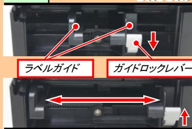
ラベルガイドの幅がラベルの幅に合っているかを確認します。合っていない場合は、ラベルガイドロックレバーを手前に引き、ラベルの幅に合わせてラベルガイドを調整します。調整後は、ラベルガイドロックレバーを元に戻します。ラベルガイドの幅がきつ過ぎると、紙送りに影響しますので注意してください。
