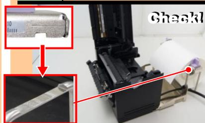
ガイドコアに新しいラベルをセットして、ガイドコアの溝を、外部供給装置のフレームの平らな部分にセットします。
