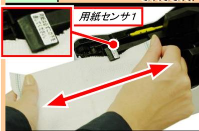
ウエスにプリンタ清掃液を染み込ませ、用紙センサ1の下に敷き、ウエスを矢印の方向に移動させて用紙センサ1の汚れを拭き取ります。用紙センサ1は精密部品の為、あまり強く清掃はせず、汚れを拭き取る程度で構いません。
