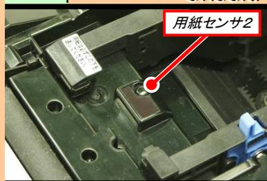
ウエスにプリンタ清掃液を染み込ませ、用紙センサ2を清掃します。用紙センサ2は精密部品の為、あまり強く清掃はせず、汚れを拭き取る程度で構いません。
