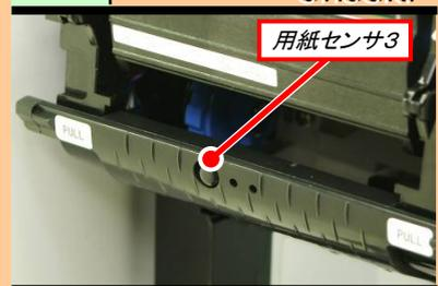
ウエスにプリンタ清掃液を染み込ませ、用紙センサ3を清掃します。用紙センサ3は精密部品の為、あまり強く清掃はせず、汚れを拭き取る程度で構いません。
