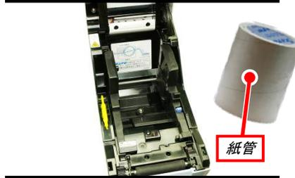
使用済みの紙管を外します。ラベルが残っている場合も外します。
