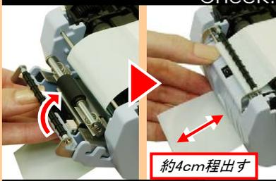
ハクリユニットの下側より約4cm程出るように台紙をセットし、用紙がたるんでいる場合は、用紙ホルダにセットしたラベルを回して巻取り、たるまないようにしてから、ハクリユニットを持ち上げながらしっかり閉じます。
