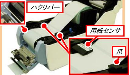
ラベルを用紙センサ及び、爪の下に通し、ハクリバーの上側からかぶせるようにして、台紙排出口に通します。ラベルルート図参照
