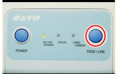
FEED/LINEキーを押すと頭出しを行い、ON LINE (POWER) ランプが点灯してオンライン状態になります。オフライン状態では、ON LINE (POWER) ランプが点滅していません。
