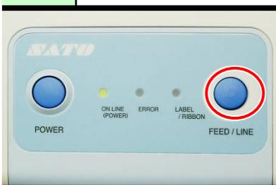
FEED/LINEキーを押すと頭出しを行い、ON LINE (POWER)ランプが点灯してオンライン状態になります。オフライン状態では、ON LINE (POWER)ランプが点滅していません。
