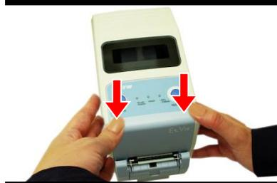
トップカバーを閉じます。このとき、上面の左右の矢印の部分を押して、「カチッ」と音がするまでしっかりと閉じてください。
