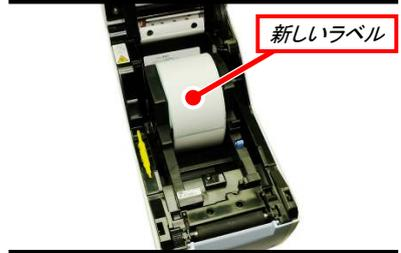
新しいラベルをプリンタにセットします。表巻き、又は裏巻きによってラベルの向きが異なります。**ラベルルート図参照**
