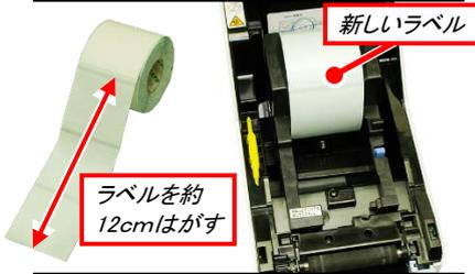
先頭のラベルをはがし、約12cm程台紙だけの状態にして、新しいラベルをプリンタにセットします。表巻き、又は裏巻きによってラベルの向きが異なります。ラベルルート図参照
