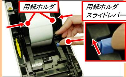
用紙ホルダスライドレバーをつまみながら、用紙ホルダを左右にスライドして用紙サイズに合わせて調整します。用紙ホルダの幅がきつ過ぎると搬送不良になる為、きつ過ぎない程度に合わせてください。
