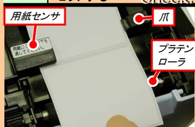
ラベルを用紙センサ及び、爪の下に通し、プラテンローラより少し前に出してセットしてください。**ラベルルート図参照**
