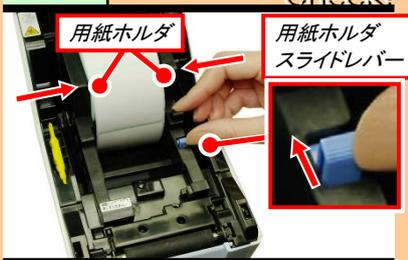
用紙ホルダスライドレバーをつまみながら、用紙ホルダを左右にスライドして用紙サイズに合わせて調整します。用紙ホルダの幅がきつ過ぎると搬送不良になる為、きつ過ぎない程度に合わせてください。
