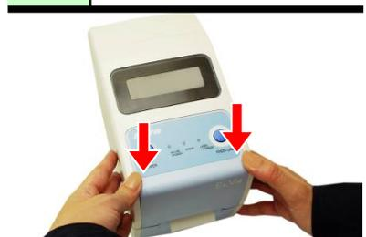
トップカバーを閉じます。このとき、上面の左右の矢印の部分を押す、“カチッ”と音がするまでしっかりと閉じてください。
