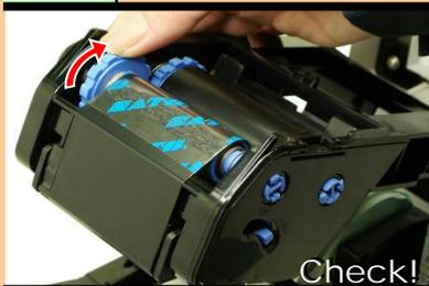
新しいリボンを、リボン巻取り部のリボンコアにシールで巻き付け、透明な部分が見えなく、リボンのシワが無くなるまで数回巻いてください。**リボンルート図参照**
