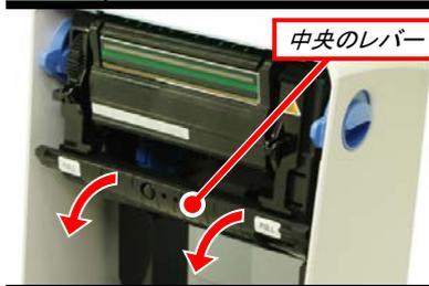
中央のレバーの左右端を手前に引き、リボンユニットを引き出します。
