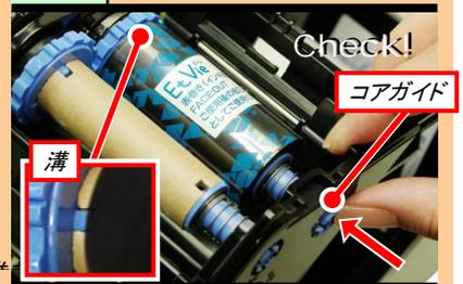
新しいリボンを、リボン供給部の右側に押し付けながらセットして、リボンコアの溝に突起がしっかりと入っている事を確認後、コアガイドを押します。**リボンルート図参照**
