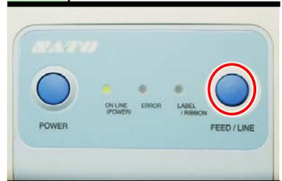
FEED/LINEキーを押すと頭出しを行い、ON LINE (POWER) ランプが点灯してオンライン状態になります。**オフライン状態では、ON LINE (POWER) ランプが点滅しています。**
