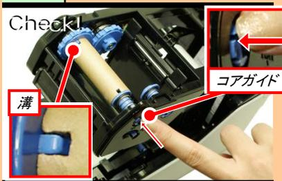
巻取り部のリボンコアの溝に突起がしっかりと入っていることを確認して、コアガイドを押します。
