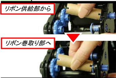
リボン供給部のリボンコアを右側に押し付けながら取り外し、外したリボンコアをリボン巻取り部へ右側に押し付けながらセットします。
