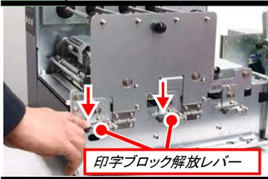
印字ブロック解放レバー(2箇所)を下方向に押し、ヘッドオープン状態にします。
