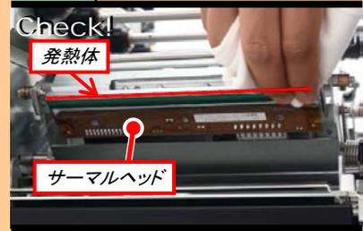
新しいウエスにプリンタ清掃液を染み込ませ、サーマルヘッドの発熱体(角の部分)を清掃します。
