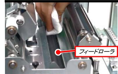
ウエスにプリンタ清掃液を染み込ませ、フィードローラを手で回しながら清掃します。
