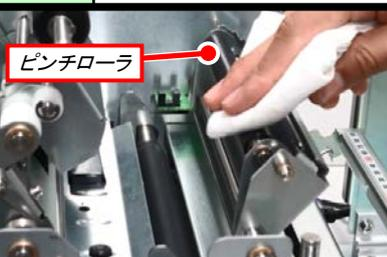
ウエスにプリンタ清掃液を染み込ませ、ピンチローラを手で回しながら清掃します。
