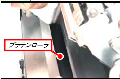
ウエスにプリンタ清掃液を染み込ませ、プラテンローラを手で回しながら清掃します。
