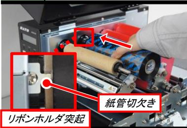
紙管の切欠きをリボンホルダ突起に合わせてセットし、奥まで差込みます。
