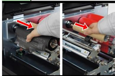
使用済みリボンと空の紙管を、手前の方向に引き抜きます。
