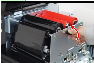
リボン軸ホルダの黒いツマミを持って、リボンガイド軸に差し込んで閉めます。
