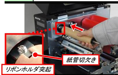
紙管の切欠きをリボンホルダ突起に合わせてセットし、奥まで差込みます。
