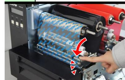
印字ブロックを「カチッ」とロックが掛かる音がするまで、押し下げてロックして下さい。
