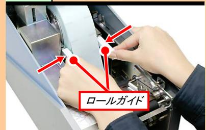
プリンタにロール紙をセットして、ロールガイドをラベルの幅に合わせます。ロールガイドの幅がきつ過ぎると搬送不良になる為、きつ過ぎない程度に合わせてください。(ラベルルート図参照)
