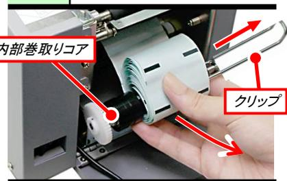
本体から内部巻取りコアを手前に外した後、クリップを横にスライドして外し、巻き取った台紙を取り除きます。
