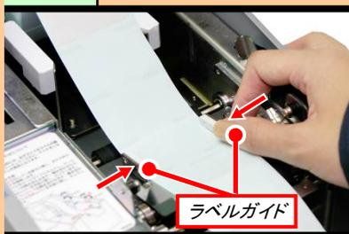
ラベルガイドをラベルの幅に合わせます。ラベルガイドの幅がきつ過ぎると搬送不良になる為、きつ過ぎない程度に合わせてください。(ラベルルート図参照)
