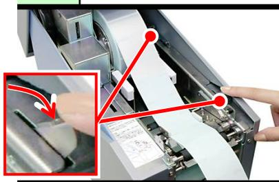
ラベルガイドロックレバーとロールガイドロックレバーを手前に倒し、ロックします。
