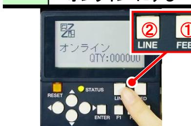
FEEDキーを数回押して、ラベルの頭出しを行なった後、LINEキーを押し"オンライン"表示にします。FEEDキーで紙送りされたラベルは取り除いてください。
