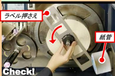
ラベル押えを手前に外し、紙管を外します。次に、新しいラベルをセットしラベル押えを奥にセットします。ラベルの向きを間違えないようにしてください。ラベルルート図参照
