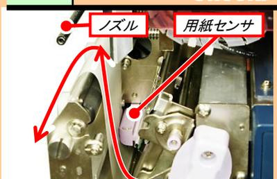
写真のように用紙センサおよび補助吹きノズルの間にラベルが通っている事を確認します。正しくセットしないと正常に動作しない事があります。
