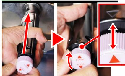
台紙巻取り部を奥に押し込み、台紙巻取りロックノブを回してセットします。その際、台紙巻取り部の▼印と、台紙巻取りロックノブの▲矢印の位置が合っている事を確認します。
