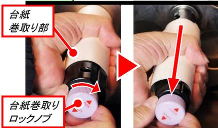
台紙巻取りロックノブを回して、台紙巻取り部を手前に引き、巻き取った台紙を外します。
