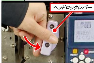
ヘッドロックレバーを矢印の方向に移動させて、ヘッドをオープンします。電源ON時でアシスト機能が動作します。手を挟まないように注意してください。
