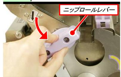
ニップロールレバーを矢印の方向に動かしてロックを解除します。
