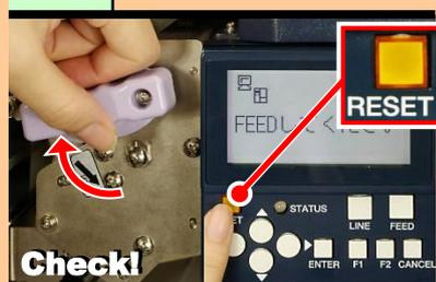
RESETキーを押しながらヘッドロックレバーを矢印の方向に移動させて、ロックします。アシスト機能が動作します。手を挟まないように注意してください。
