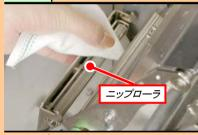
ウエスにプリンタ清掃液を染み込ませ、ニップ ローラを手で回しながら清掃します。
