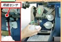
ースプレーで用紙センサの汚れを吹き 飛ばします。
