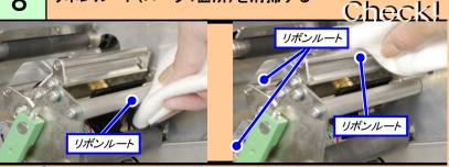
ウエスにプリンタ清掃液を染み込ませ、リボンルートを清掃します。 清掃箇所図を参照
