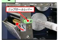
ニップロールレバーを矢印の方向に動かし てロックを解除します。
