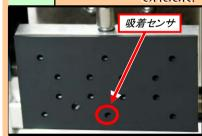
エアースプレーで吸着センサの汚れを 吹き飛ばします。
