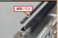
ウエスにプリンタ清掃液を染み込ませ、補 助ノズルを清掃します。
