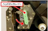
ヘッドロックレバーを矢印の方向に動かし て、ヘッドをオープンします。
