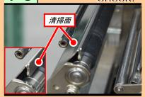
ウエスにプリンタ清掃液を染み込ませ、清 掃面を清掃します。
