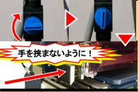
ハンドバルブを右回しにすると、エア一回 路がONになり、シリンダが戻ります。シリ ンダに手を挟まないように充分注意をしてください。
