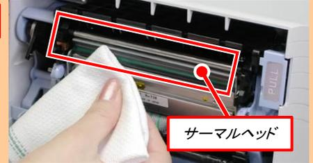
新しいウエスにプリンタ清掃液を染み込ませ、サーマルヘッドを清掃します。
