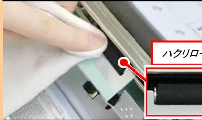
ウエスにプリンタ清掃液を染み込ませ、ハクリローラを手で回しながら清掃します。
