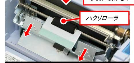
ハクリユニットの"PUSH DOWN"上側の凸加工部分を、上から押しながら手前に開けるとハクリローラが見えるようになります。
