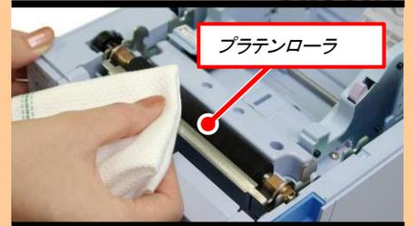
ウエスにプリンタ清掃液を染み込ませ、プラテンローラを手で回しながら清掃します。
