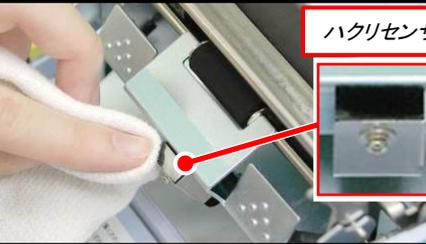
ウエスにプリンタ清掃液を染み込ませ、ハクリセンサを清掃します。
