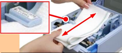
ウエスにプリンタ清掃液を染み込ませ、用紙センサの下に敷き、ウエスを前後に移動させて用紙センサの汚れを拭き取ります。
