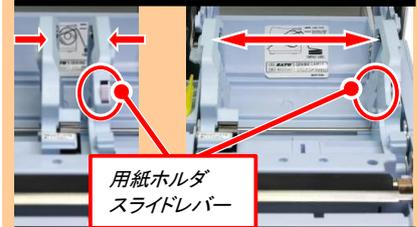
紫色の用紙ホルダスライドレバーを押しながら、用紙ホルダをラベルの幅に合わせます。用紙ホルダの幅がきつ過ぎると、紙送りに影響しますので注意してください。
