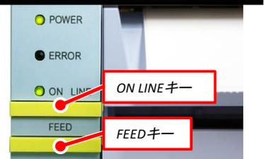
FEEDキーを押して頭出しを行った後、ON LINEキーを押しON LINEにします。
