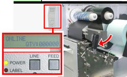
ラベルがセットされている事を確認し、ヘッドクローズレバーを下げて、ヘッドをロックします。次にFEEDキーを押して、ラベルの頭出しを行なった後、LINEキーを押しON LINE状態にします。
