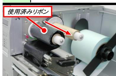
リボン巻取り部の使用済みリボンを手前の方向に引き抜きます。
