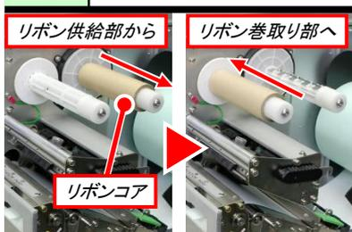
リボン供給部のリボンコアを手前の方向に引き抜き、リボン巻取り部の奥まで差し込みセットします。
