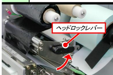
ヘッドロックレバーを矢印の方向に上げ、サーマルヘッドをオープン状態にします。
