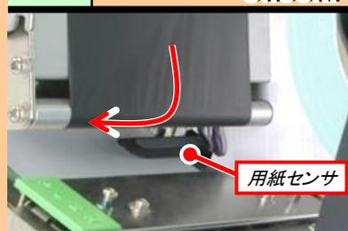
用紙センサの上にリボンが通っている事を確認します。用紙センサの下にリボンを通すと故障の原因になります。
