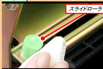
ウエスにプリンタ清掃液を染み込ませ、スライドローラを清掃します。
