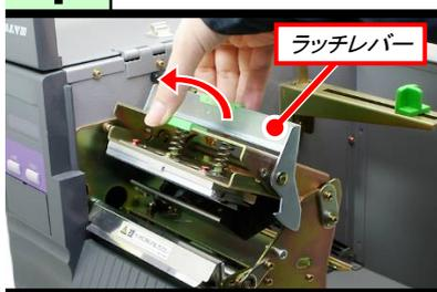
ラッチレバーを、矢印方向に引き、サーマルヘッド部を上を持ち上げます。
