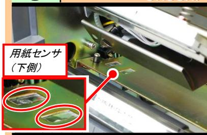
ウエスにプリンタ清掃液を染み込ませ、2箇所用の紙センサ(下側)を清掃します。
