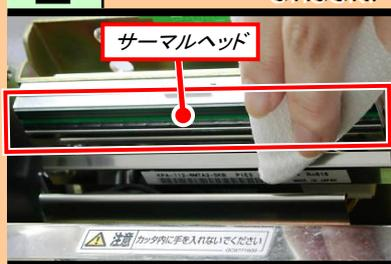
新しいウエスにプリンタ清掃液を染み込ませ、サーマルヘッドを清掃します。
