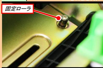
ウエスにプリンタ清掃液を染み込ませ、固定ローラを清掃します。
