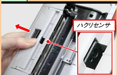
綿棒にプリンタ清掃液を染み込ませ、カバー開閉レバーを矢印の方向にスライドさせながら、ハクリセンサを清掃します。精密部品の為、汚れをふき取る程度で構いません。
