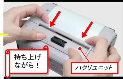
電源が切れている事を確認した後、ハクリユニットを上を持ち上げながら、連続発行モードの位置にスライドさせます。
