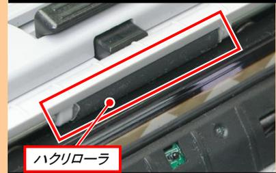
ウェスにプリンタ清掃液を染み込ませ、ハクリローラを手で回しながら清掃します。
