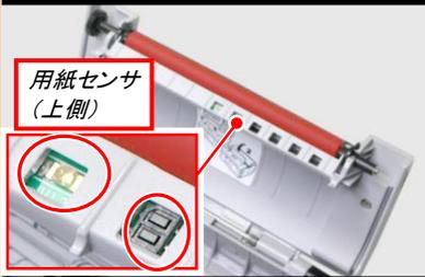
ウェスにプリンタ清掃液を染み込ませ、2箇所用の紙センサ(上側)を清掃します。精密部品の為、汚れをふき取る程度で構いません。
