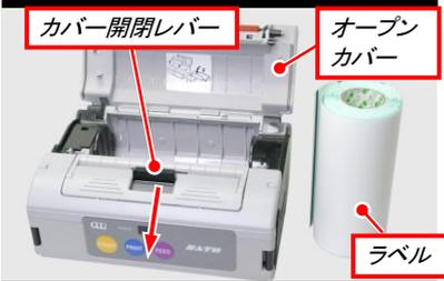
カバー開閉レバーを矢印の方向にスライドさせ、オープンカバーを開けてラベルを取り除きます。
