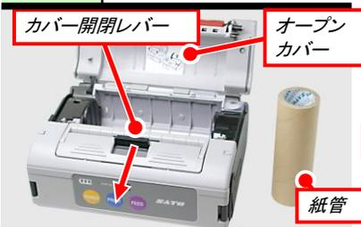
カバー開閉レバーを矢印の方向にスライドさせ、オープンカバーを開けて紙管を取り除きます。
