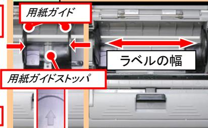
紫の用紙ガイドストップを奥の方向(矢印の刻印の方向)に押しながら、用紙ガイドをラベルの幅に合わせます。用紙ガイドの幅がきつ過ぎると、紙送りに影響しますので注意してください。
