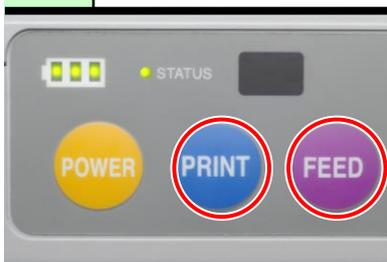
FEEDキーを押して、ラベルの頭出しを行なった後、PRINTキーを押してON LINE状態にします。
