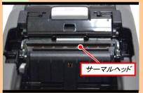
新しいウエスにプリンタ清掃液を染み込ませ、サーマルヘッドを清掃します。 ※カッタで手を切らないように注意して下さい。
