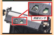
ウエスにプリンタ清掃液を染み込ませ、用紙 センサ(上側)2箇所を清掃します。 精密部品の為、汚れをふき取る程度で構い ません。
