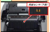
新しいウエスにプリンタ清掃液を染み込ませ、用紙センサ(下側)を清掃します。 精密部品の為、汚れをふき取る程度で構しません。
