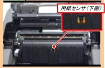
ウエスにプリンタ清掃液を染み込ませ、用紙 センサ(下側)を清掃します。 精密部品の為、汚れをふき取る程度で構い ません。
