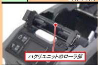
ウエスにプリンタ清掃液を染み込ませ、ハ クリユニットのローラ部に付着した糊ダマ リ等を取り除きます。
