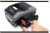
プリンタの電源を切った後、矢印の方向へ バッテリーを引き抜きます。
