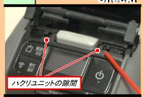
エアースプレーでハクリユニットの隙間に溜 まった紙粉を清掃します。
