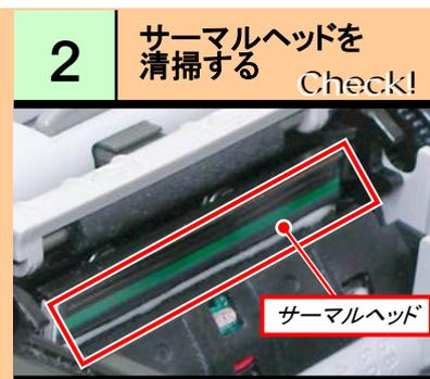
新しいウエスにプリンタ清掃液を染み込ませ、サーマルヘッドを清掃します。
