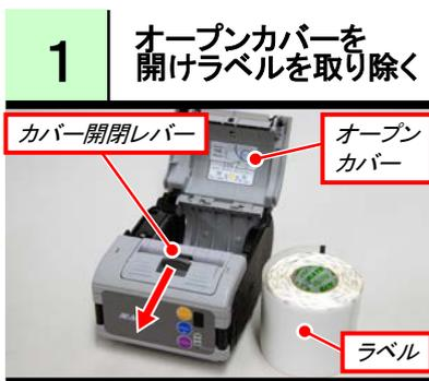
プリンタの電源が切れている事を確認した後、カバー開閉レバーを矢印の方向にスライドさせ、オープンカバーを開けてラベルを取り除きます。
