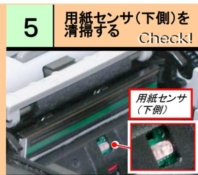
ウエスにプリンタ清掃液を染み込ませ、用紙センサ(下側)を清掃します。用紙センサ(下側)は精密部品の為、あまり強い力を加えないでください。
