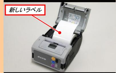
新しいラベルをセットします。ロールの向きを間違えないようにしてください。ラベルルート図参照
