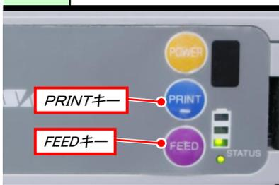
FEEDキーを1回押して、ラベルを1枚紙送りした後、PRINTキーを押してON LINE状態にします。紙送りしたラベルは取り除いてください。
