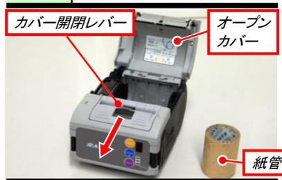
カバー開閉レバーを矢印の方向にスライドさせ、オープンカバーを開けて紙管を取り除きます。ラベル、台紙が残っている場合は取り除いてください。
