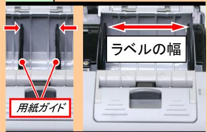
用紙ガイド調整ダイヤルを回し、用紙ガイドをラベルの幅に合わせます。ラベルの幅に合わせた後は、用紙ガイド調整ダイヤルカバーを閉じてください。用紙ガイドの幅がきつ過ぎると、紙送りに影響しますので注意してください。
