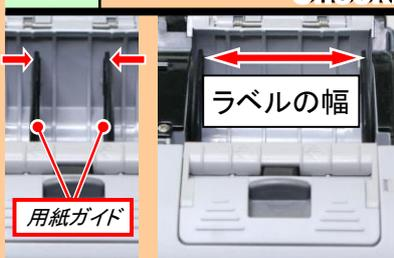
用紙ガイド調整ダイヤルを回し、用紙ガイドをラベルの幅に合わせます。ラベルの幅に合わせた後は、用紙ガイド調整ダイヤルカバーを閉じてください。用紙ガイドの幅がきつ過ぎると、紙送りに影響しますので注意してください。
