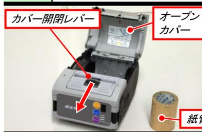
カバー開閉レバーを矢印の方向にスライドさせ、オープンカバーを開けて紙管を取り除きます。ラベルが残っている場合は取り除いてください。
