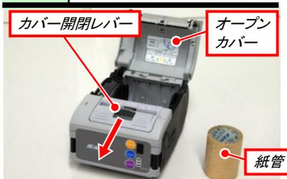
カバー開閉レバーを矢印の方向にスライドさせ、オープンカバーを開けて紙管を取り除きます。ラベルが残っている場合は取り除いてください。
