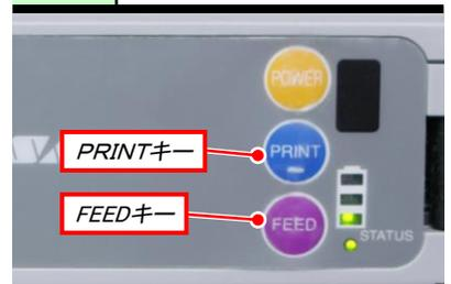
FEEDキーを押して、ラベルの頭出しを行なった後、PRINTキーを押してON LINE状態にします。
