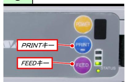
FEEDキーを数回押して、ラベルを1枚ハクリした後、PRINTキーを押してON LINE状態にします。
