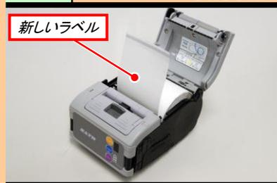
新しいラベルをセットします。ロールの向きを間違えないようにしてください。ラベルルート図参照
