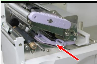
センサの溝に合わせ、ピッチセンサガイドを奥まで差込みセットします。
