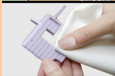
ウエスにプリンタ清掃液を染み込ませ、ピッチセンサガイドを清掃します。**ラベルが貼り付いている場合は取り除いてください。**
