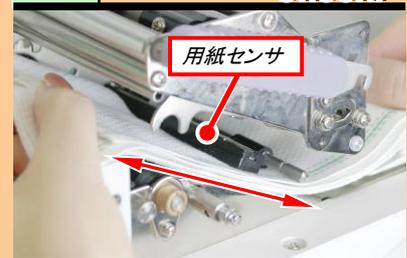
ウエスにプリンタ清掃液を染み込ませ、用紙センサの下に敷き、ウエスを上下に移動させて用紙センサの汚れを拭き取ります。
