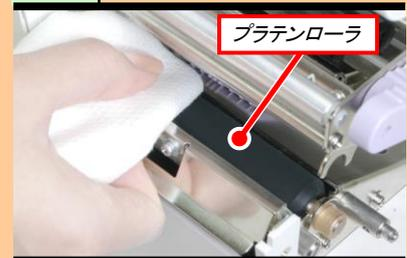
ウエスにプリンタ清掃液を染み込ませ、プラテンローラを手で回しながら清掃します。
