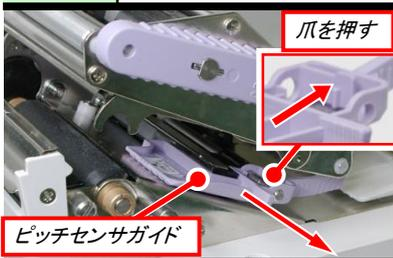
ピッチセンサガイドの爪を矢印の方向に押しながら手前に引き、ピッチセンサガイドを外します。
