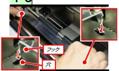
左右の用紙押えのフックを左右の四角い穴に押し込んでセットします。左右のフックが穴に入っていない状態で無理やり押さえ込むと用紙押さえが変形してしまい、搬送不良等が発生するので気を付けてセットしてください。
