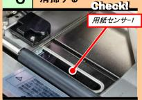
ウエスにプリンタ清掃液を染み込ませ、用 紙センサー1を清掃します。
