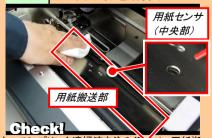
ウエスにプリンタ清掃液を染み込ませ、用紙搬送部を清掃して、用紙搬送部の中央部の用紙センサー2の埃を、エアースプレーで噴き飛ばします。ラベルが貼り付いている場合は取り除いてください。
