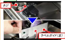
ラベルガイド(左)を固定しているネジを外し、 ラベルガイド(左)を上に引き外します。セン サーケーブルを断線させない様、注意して 取り外してください!
