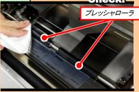
ウエスにプリンタ清掃液を染み込ませ、左右のプレッシャローラを手で回しながら清掃します。
