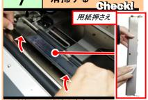
用紙押えの両側を上方向に引いて外し、 ウエスにブリンタ清掃液を染み込ませ、用 紙押さえを清掃します。ラベルが貼り付い ている場合は取り除いてください。
