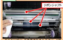
ウエスにプリンタ清掃液を染み込ませ、3箇 所のリボンシャフトを清掃します。
