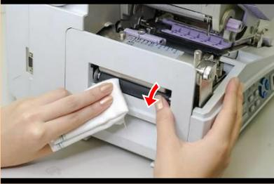
ウエスにプリンタ清掃液を染み込ませ、排出ローラを手で下方方向に回しながら清掃します。上方方向には回しません。
