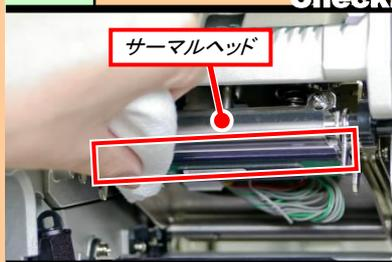
新しいウエスにプリンタ清掃液を染み込ませ、サーマルヘッドを清掃します。※上の写真は解りやすい様にカッタユニットを外しています。
