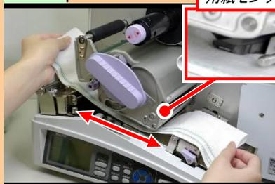
ウエスにプリンタ清掃液を染み込ませ、用紙センサの下に敷き、ウエスを左右に移動させて用紙センサの汚れを拭き取ります。
