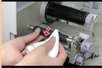
ウエスにプリンタ清掃液を染み込ませ、リボンフィードローラを手で回しながら清掃します。
