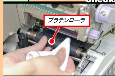
ウエスにプリンタ清掃液を染み込ませ、プラテンローラを手で回しながら清掃します。※上の写真は解りやすい様にカッタユニットを外しています。
