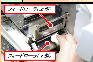
ウエスにプリンタ清掃液を染み込ませ、フィードローラ(上側)と(下側)を清掃します。ラベルが貼り付いている場合は取り除いてください。
