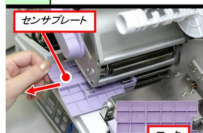
センサプレートのフックを押し、手前に引き出して外します。
