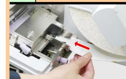
リッドラッチの下にタグを差し込むと、自動給紙機能が動作します。タグが止まったらタグルートを確認してください。**タグルート図を参照**
