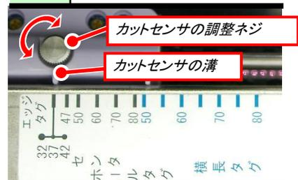
カットセンサの調整ネジを緩め、カットセンサの溝を使用するタグの目盛りに合わせ移動させます。タグの横幅や種類の変更が無ければ合わせる必要はありません。
