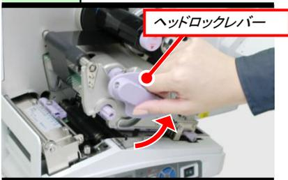
ヘッドロックレバーを矢印の方向に上げ、サーマルヘッドをオープン状態にします。
