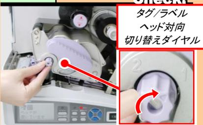
タグ/ラベルヘッド対向切り替えダイヤルを“1”にセットします。“1”（右側）：タグ/ラベル兼用（通常）“2”（左側）：ラベル（高印字品質）タグは“1”にセットし、ヘッドは必ずオープンにしてからセットして下さい。
