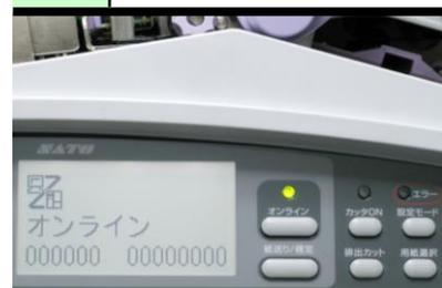
タグが自動に引き込まれた後、ディスプレイに“オンライン”と表示されている事を確認します。電源が入っていない場合は電源を入れ、用紙選択キーにて用紙種を合わせた後、自動給紙してください。
