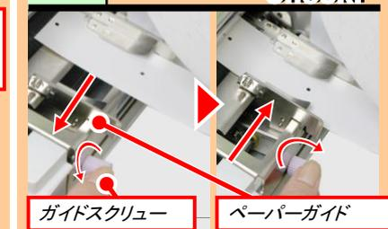
ガイドスクリューを緩め、ペーパーガイドをスライドしてタグの幅に合わせ、ガイドスクリューを締めます。幅合わせ後は、タグはまだ外しておいて下さい。（自動給紙の為）ペーパーガイドの幅がきつ過ぎると、紙送りに影響しますので注意してください。
