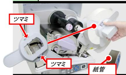
ツマミを押しながらロール紙押えを外し、紙管を外します。そして、新しいタグをセットし、ツマミを押しながらロール紙押えをセットします。
