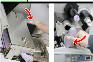
リッドラッチと、ヘッドロックレバーを下げてロックします。
