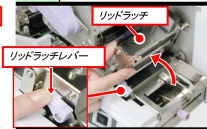
リッドラッチレバーを押し、リッドラッチを上げます。
