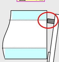
図11にあるラベルロール径が約60ミリより少ないラベルロールを挿入すると、図12の丸印部分でラベルガイドピンがラベルに当たりラベル紙管の中に入ることが出来ずラベルを支えることが出来ません
