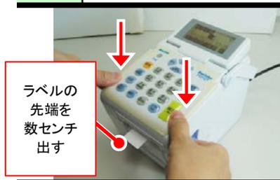
ラベルの先端を開口部から数センチ出した状態で、トップカバーの両端を均一な力でカチッと音がするまでしっかり閉じてください。
