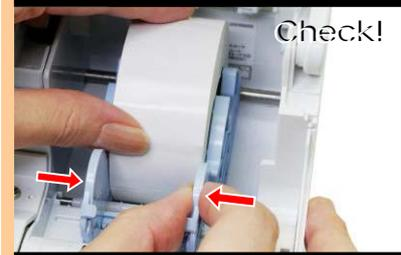
用紙ガイドがラベルの幅に合っている事を確認します。合っていない場合は、用紙ガイドをラベルの幅に合わせます。用紙ガイドの幅がきつ過ぎると、紙送りに影響しますので、用紙ガイドはラベルの両端に少し
