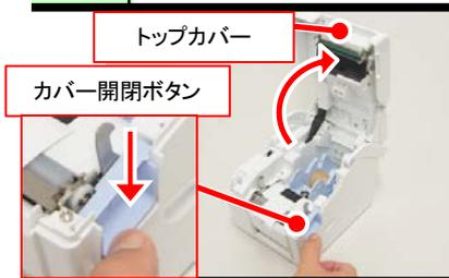
カバー開閉ボタンを押し、トップカバーを開けてラベルを外します。
