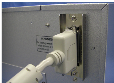
パラレルケーブル接続
