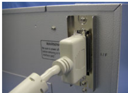
パラレルケーブル接続
