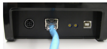
LAN ケーブル接続
