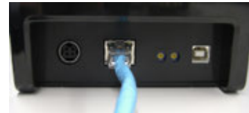
LAN ケーブル接続
