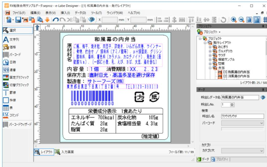
Windows コンピュータにインストールして使用します。コンピュータで印字イメージを確認できるので、ラベルデザインを簡単に作成、編集することができます。作成したラベルデータを SATO App Storage などのサーバ経由や USB 経由で e-Labe Print に登録（プリセット）します。
