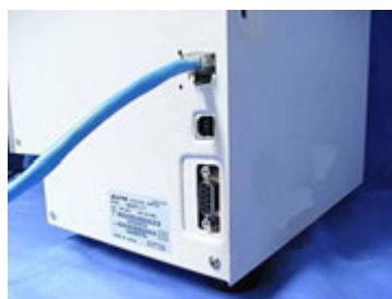
LAN ケーブル接続
