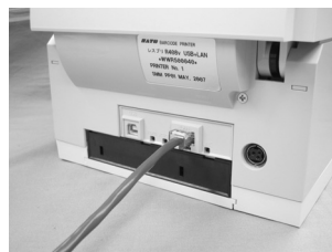
図 2.2 LAN ケーブル接続
