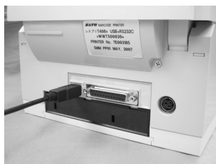
図 1.4 USB ケーブル接続
