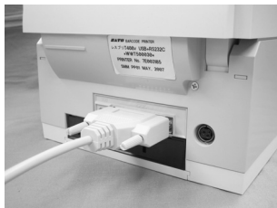
図 3.2 RS-232C ケーブル接続
