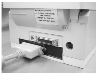
図 4.2 パラレルケーブル接続
