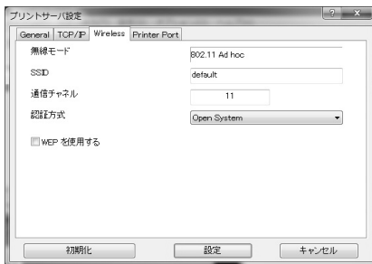
「Ad Hoc」モード (ディップスイッチ(DSW) : OFF 設定)
