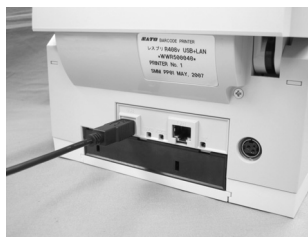
図 1.2 USB ケーブル接続
