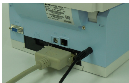
パラレルケーブル接続
