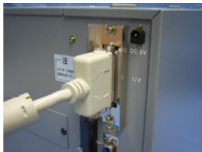
パラレルケーブル接続
