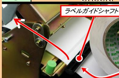
ラベルガイドシャフトの下にラベルが通っている事を確認します。ラベルガイドシャフトの上にラベルを通すと故障の原因になります。ラベルルート図参照
