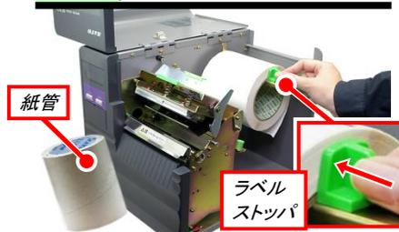
使用済みの紙管を外し、新しいラベルを供給ブラケットにセットします。次にラベルストップをラベルの幅に合わせます。ラベルストップの幅がきつ過ぎると、紙送りに影響しますので注意してください。
