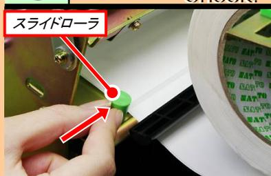
スライドローラをラベルの幅に合わせます。スライドローラの幅がきつ過ぎると、紙送りに影響しますので注意してください。
