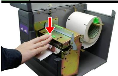
サーマルヘッド部を強く押し上げヘッドを閉めます。カチッと音がして、ラッチレバーが固定されたことを確認してください。
