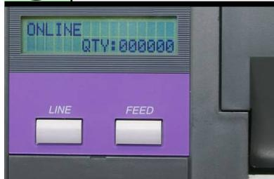
FEEDキーを数回押して、ラベルの頭出しを行なった後、LINEキーを押し"ONLINE"表示にします。FEEDキーで紙送りされたラベルは取り除いてください。
