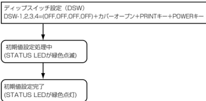
注記) 初期値設定モードを終了する場合は、STATUS LEDが緑色点灯していることを確認してから電源を切ってください。初期値設定モードの完了後、必ずディップスイッチ (DSW) 設定を元に戻してください。
