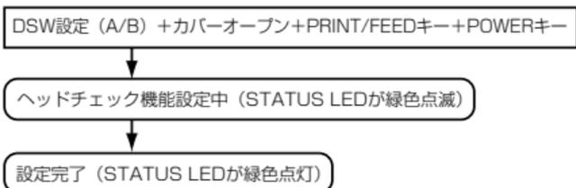
注記) ヘッドチェック設定モードの設定内容の確認は、テスト印字の印字内容で確認してください(43 ページ)。
