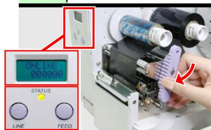
ラベルがセットされている事を確認し、ヘッドロックレバーを下げて、ヘッドをロックします。次にFEEDキーを押して、ラベルの頭出しを行なった後、LINEキーを押してON LINE状態にします。
