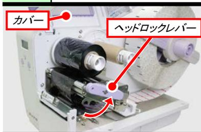
カバーを開け、ヘッドロックレバーを上げて、ヘッドオープン状態にします。
