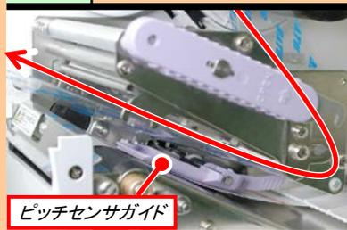
ピッチセンサガイドの上リボンが通っている事を確認します。ピッチセンサガイドの下にリボンを通すと故障の原因になります。
