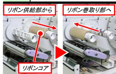
リボン供給部のリボンコアを手前の方向に引き抜き、リボン巻取り部の奥まで差し込
