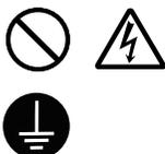
必ずプリンタのアース線をアースへ接続してください。アース線を接続しないと感電の原因になります。
