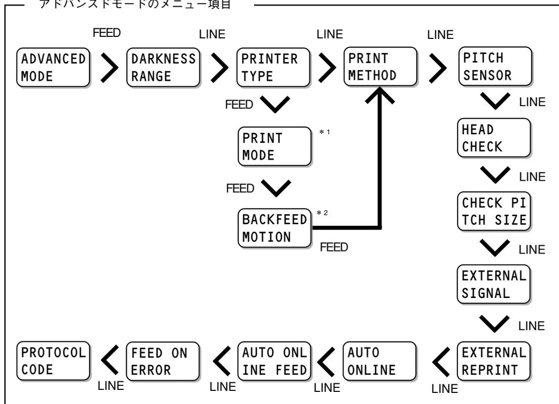
\* 1 “PRINTER TYPE” の設定確定後、“PRINT MODE” の画面に移行します。
