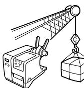
クレーンやプレス機など大容量の電気を使う機器は、電気ノイズや電源の電圧低下を起こす原因になります。本プリンタの誤動作や故障のもとになりますので、これらの機器のそばに本プリンタを置かないでください。
