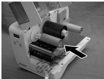
**⑤** カーボンリボンをリボン供給部からサーマルヘッドの下を通して、リボン巻き取り部へ通します。
